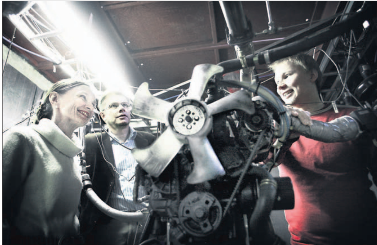
KELLARIPAJA Kun moottori pauhaa, on pienessä kellarissa ääntä, muttei pakokaasua. Ne kerätään kerrosta ylempänä talteen pienhiukkasmittauksia varten. Laboratorion pohjakerrosta esittelevät professorit Maija-Riitta Hirvonen ja Jorma Jokiniemi sekä tutkija Mika Ihalainen (oik.).
